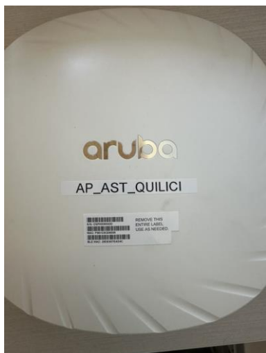
Figure 10 : Ceci est une borne wifi Aruba AP-505
