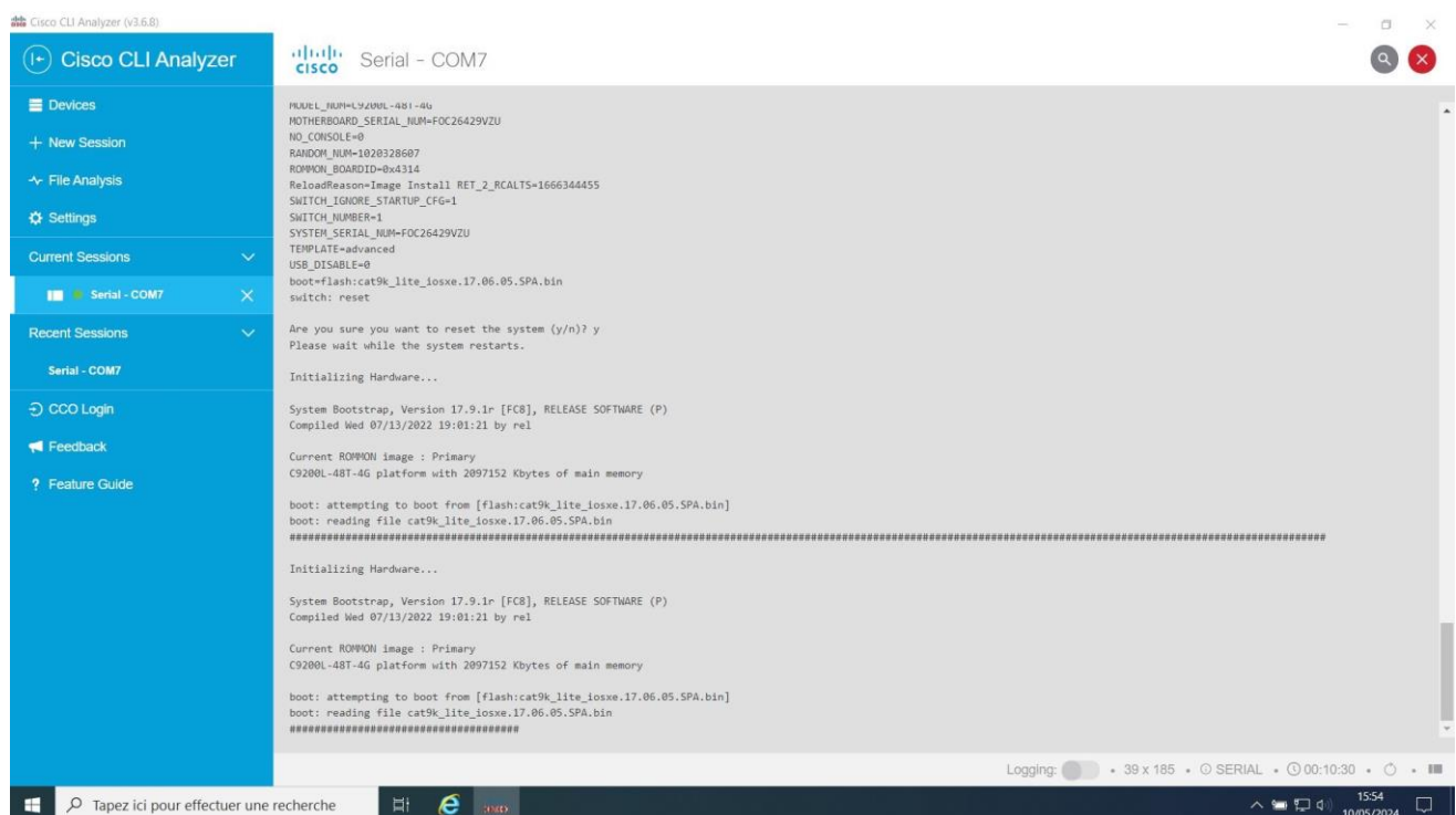
Figure 15: Switch Cisco Catalyst 9200 qui redémarre en boucle
