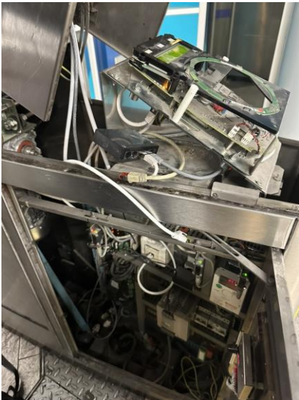
Figure 18: Ceci est l'intérieur d'un PAF première génération
